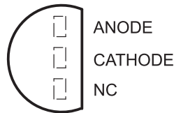
LM285-1.2, LM385-1.2, LM385B-1.2 . . . LP PACKAGE (TOP VIEW)
